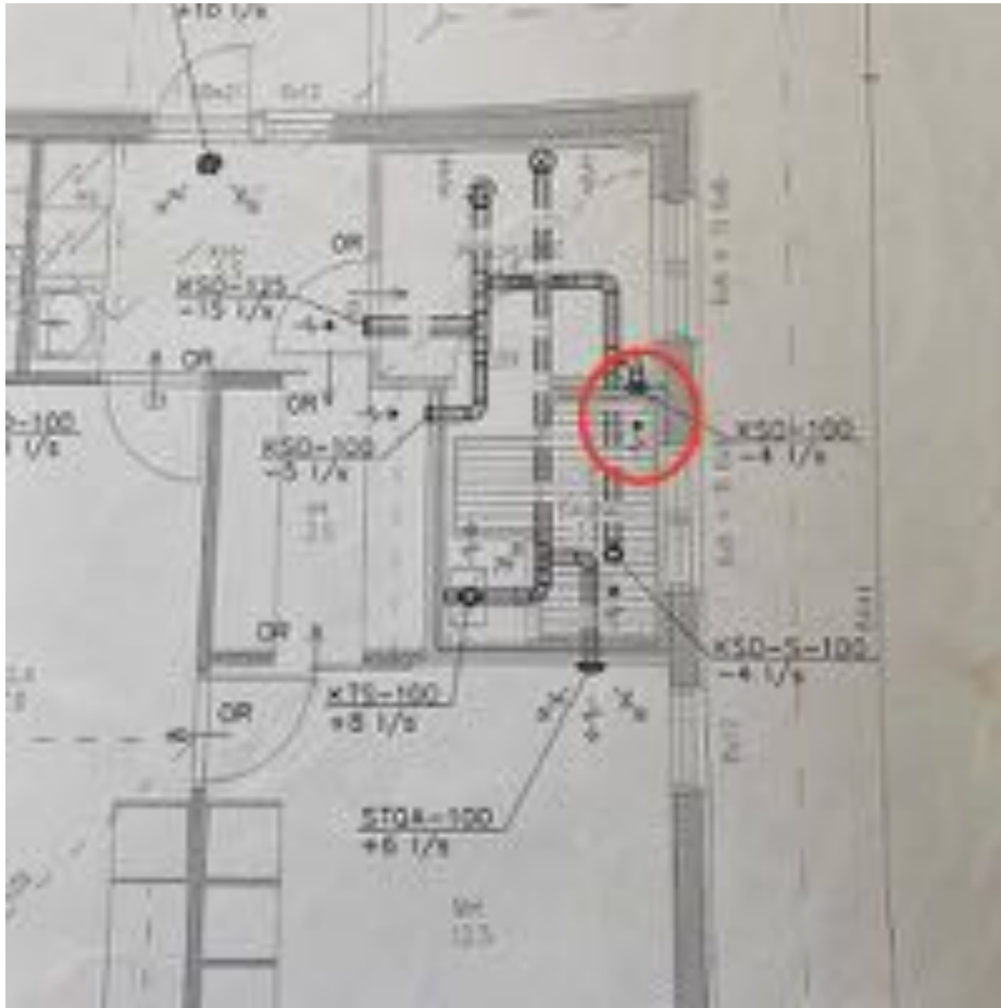
58. Huomio: Suunnitelmissa esitettyä poistoilmaventtiiliä (KSO-100) ei ole asennettu saunan lauteiden alle.
